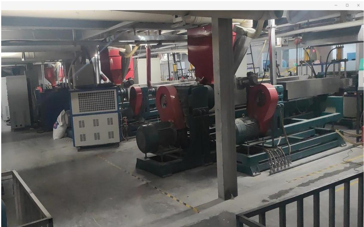
照片 4-1 挤出、吸塑成型工序
